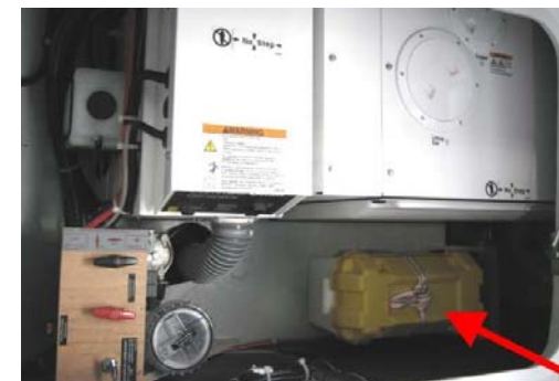
Generator battery: 1 x 110A
